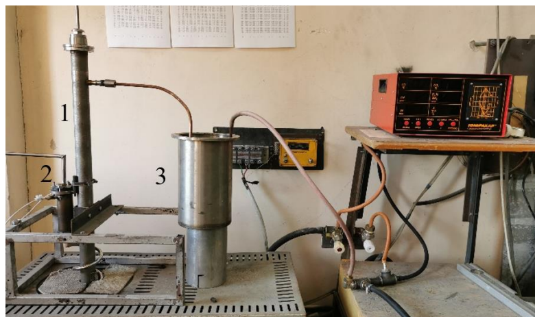
Установка по исследованию состава образующихся газов в лабораторном шахтном реакторе с внешним нагревом
