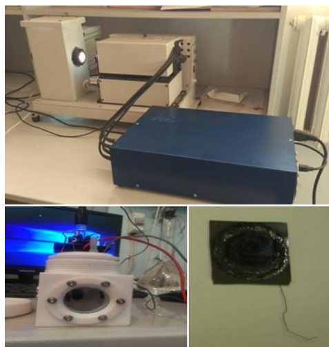
Установка для тестирования ячейки PEC
