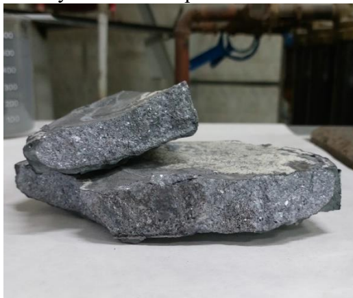
Рисунок 1 – Процесс получение металлургического кремния из кварцевой мелочи: а) в индукционной печи, б) металлургический кремний из мелкодисперсных отходов ферросплавного производства микрокремнизема
