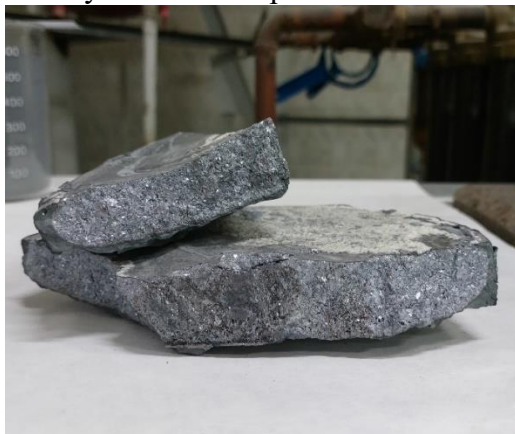
Рисунок 1 – Процесс получение металлургического кремния из кварцевой мелочи: а) в индукционной печи, б) металлургический кремний из мелкодисперсных отходов ферросплавного производства микрокремнезема
