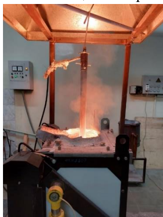
Рисунок 1 – Процесс получение металлургического кремния из кварцевой мелочи: а) в индукционной печи, б) металлургический кремний из мелкодисперсных отходов ферросплавного производства микрокремнезема
